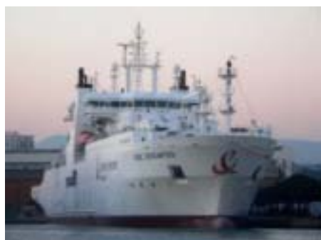
海底ケーブル敷設船
